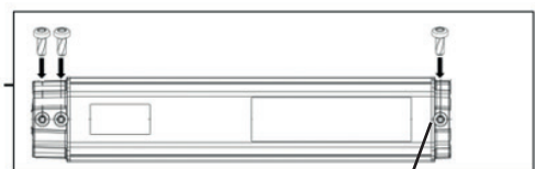
Fig.2 lato inferiore batteria 3 punti di fissaggio per viti M6, fissaggio 8Nm
